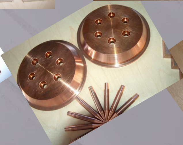
Hammerelektrode für Tischpunktschweißmaschine mit Einspannkonus 10:1 Material CuCoBe Abmessung: 30 x 75 mm
